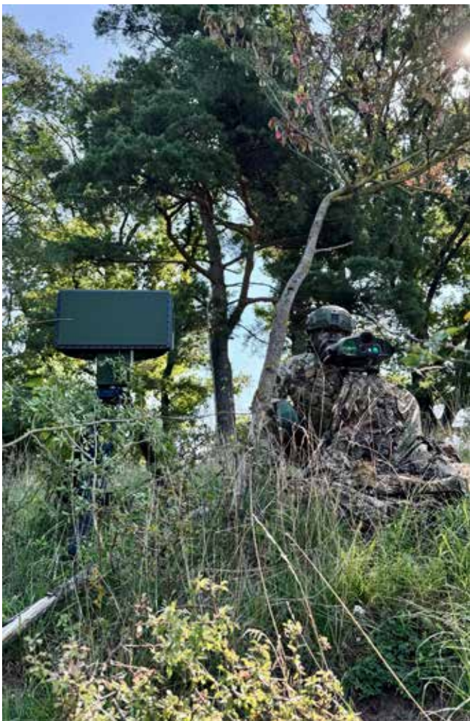
Thales GO12-Bodenüberwachungsradar und Thermalkamera Sophie Ultima im Einsatz.
